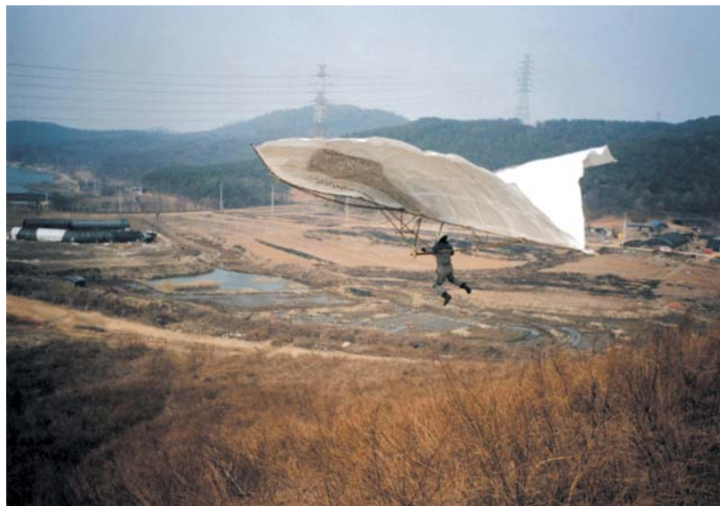
건국대학교 항공우주공학과 비거연구팀이 설계/제작에 성공하여 하늘을 나는 모습. 1/2의 크기로 축소 제작된 모형비거는 현재 공군사관학교 박물관에 전시되어 있음.
